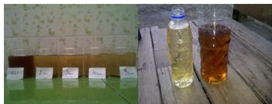
Gambar 2: Hasil Penjernihan Air Gambut Dengan Berbagai Dosis Kapur Sirih
