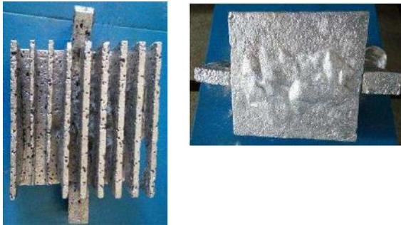
**Gambar 12:** Hasil coran dengan posisi pola sirip terletak di bawah, 3 kali *coating* dengan *in gate* searah sirip dan 1 buah *riser*
