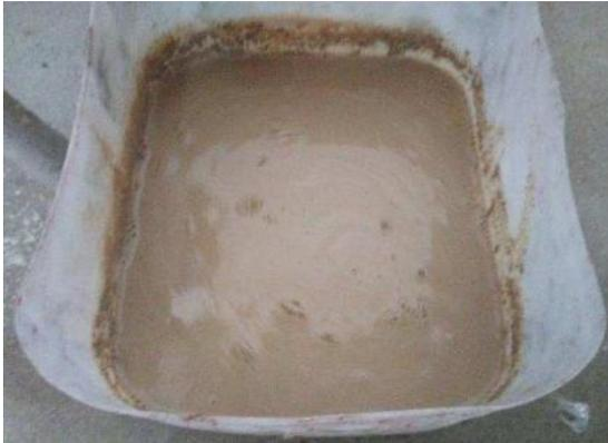
**Gambar 2:** Material *coating* hasil pencampuran antara *colloidal silica* dengan kaolin
