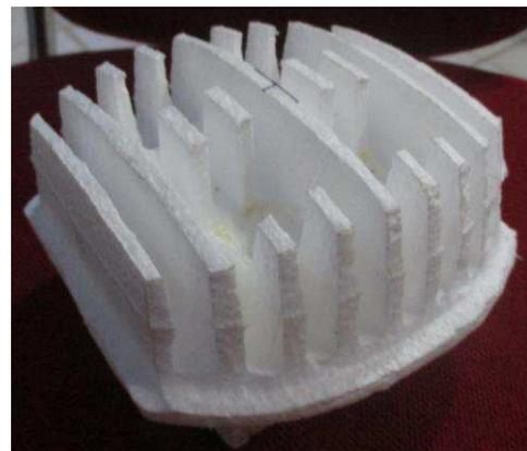
**Gambar 5:** Pola hasil pembentukan menggunakan mesin CNC
