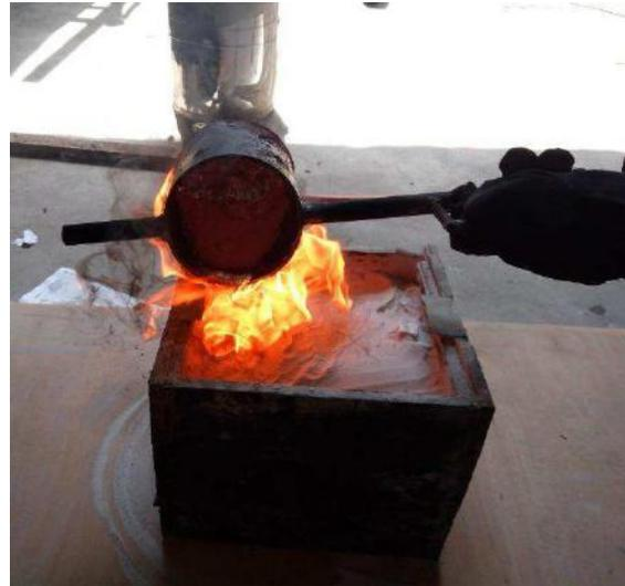
**Gambar 4:** Proses penuangan logam cair ke dalam cetakan
