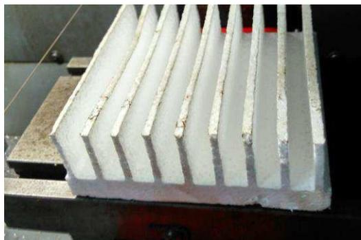
**Gambar 6:** Proses pembuatan pola pendekatan menggunakan mesin CNC
