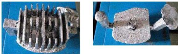
**Gambar 13:** Hasil coran pola 1 sirip terletak di bawah dengan 2 kali *coating* dengan *in gate* di tengah dan dua buah *riser*
